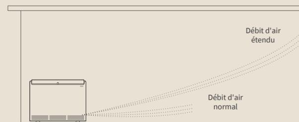
La distribution de l'air chaud vers la partie inférieure de la pièce permet d'atteindre rapidement la température souhaitée et de la maintenir constante.
